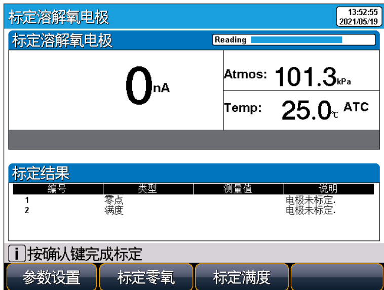
图 5-5 溶解氧标定示意图
