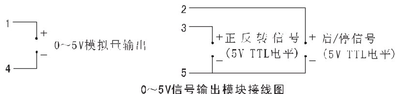
0~5V信号输出模块接线图
